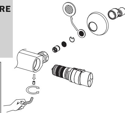
1- Cerrar llaves de paso de la instalación. Desconectar la grifería de la red; sobre las dos entradas se hallan instalados los filtros suplementarios.
