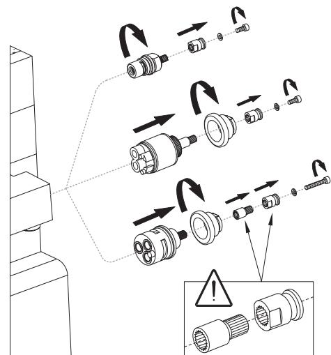
**MONTAJE Y LIMPIEZA FILTRO ESCÉNTRICO • MONTAGE ET NETTOYAGE DU FILTRE DU RACCORD EXCENTRE
