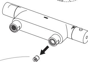
Válvula antiretorno · clapet anti-retour · Rückschlagventil · Keerklep · valvola antiritorno
